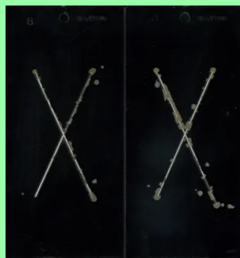
ZRシリーズ （18m 2 /L処理後） テープ剥離幅： 1～3mm
