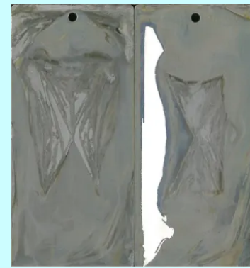
リン酸鉄皮膜剤 （耐食性比較用） テープ剥離幅： テープ幅（18mm）
