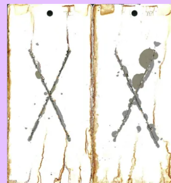
リン酸亜鉛皮膜剤 （耐食性比較用） テープ剥離幅： 2～12mm
